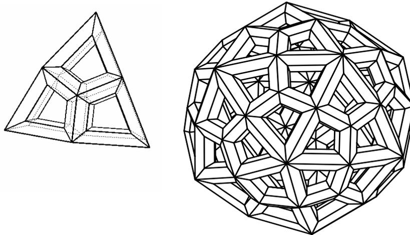
Die Abb. zeigt das Facettenstück und das so erzeugte Kantenmodell des Deltoid – 60 – Flächners.
