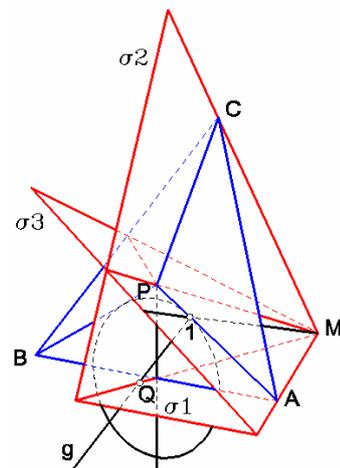
Die folgende Abbildung zeigt ein prismatisches Teilstück (Extrusion längs [Q1]), das als „Elementarstück“ für dieses Polyeder dienen kann, sowie das sich daraus ergebende „Facettenstück“ und das gesamte Stabmodell („Polyeder“).
